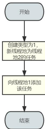
图 4-11 borrow_threads 流程图
